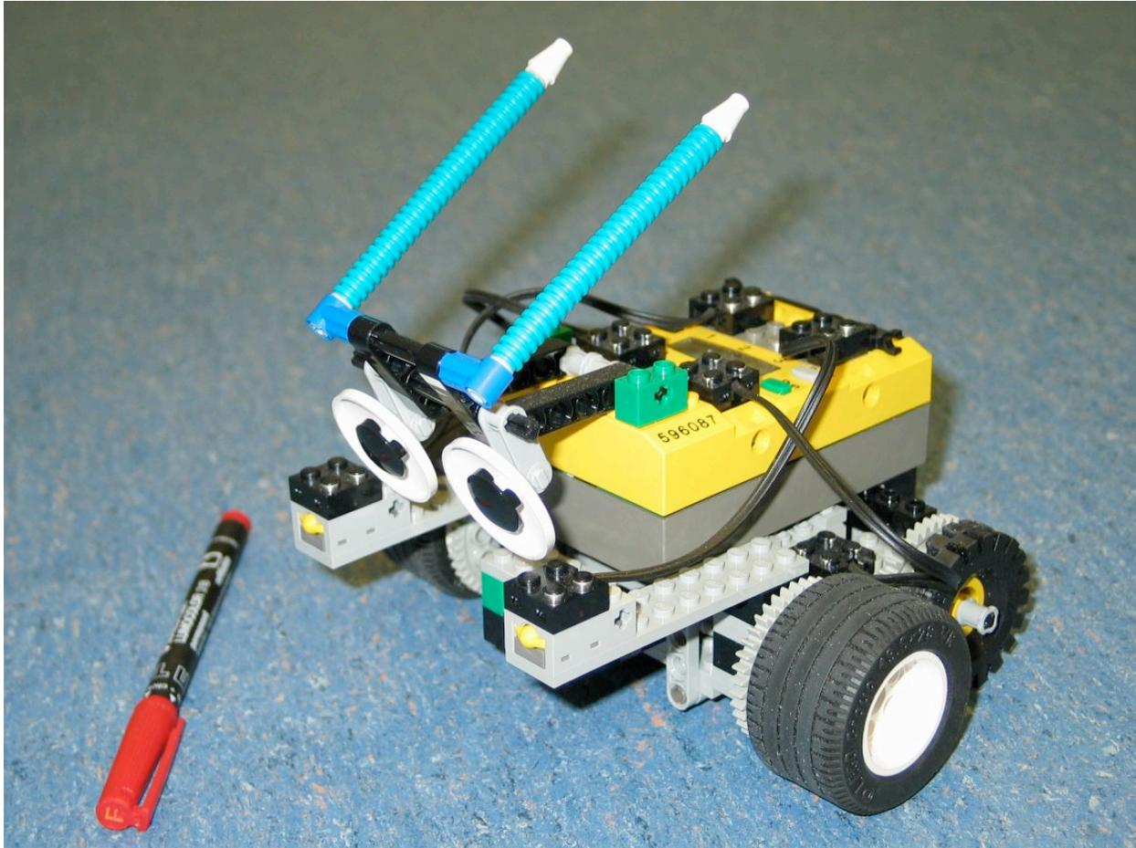
*Fig. 3. Uso de un robot para visualización de comportamiento caótico. El robot se mueve de acuerdo al resultado de una ecuación diferencial caótica como el atractor de Chua.*
